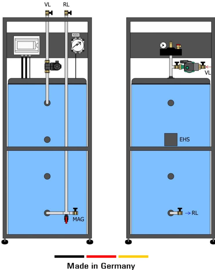
Hocheffiziente elektronisch geregelte Pufferspeicherstation für sämtliche Wärme-erzeuger in Verbindung mit dem Hausanschluss Modul HTW10 PS. Die Anlage ist anschlussfertig in kompakter Bauweise in einem Stück aufgebaut. Die Bauteile sind bis auf die Pumpenverschraubungen wärmege-dämmt verbaut. Alle elektrischen Komponenten sind mit dem fest installierten Heizungsregler verkabelt.
